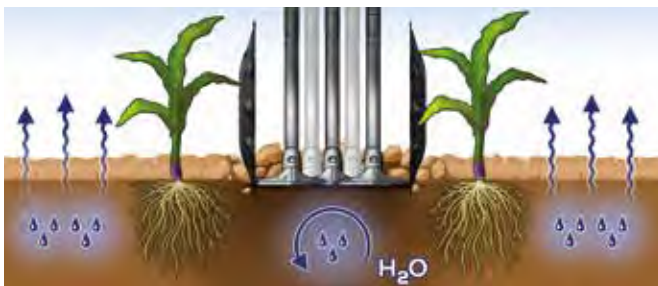
Brytning av kapilläriteten i raderna betyder reducerad avdunstning under torrperioden
